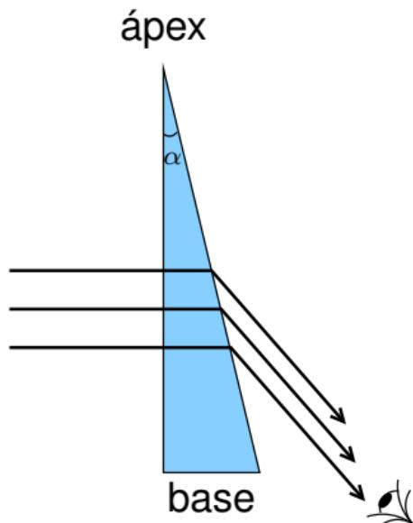
**Prisma** → elemento óptico que não causa vergência do feixe incidente mas apenas muda a sua direcção de propagação.
